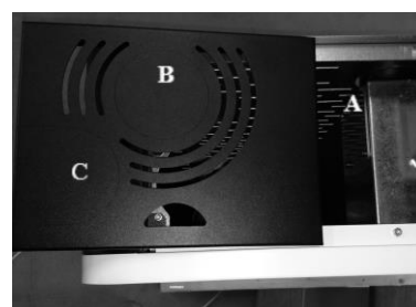
A-zaślepka B-wyjście DGP C-wyjście odprowadzenia spalin
